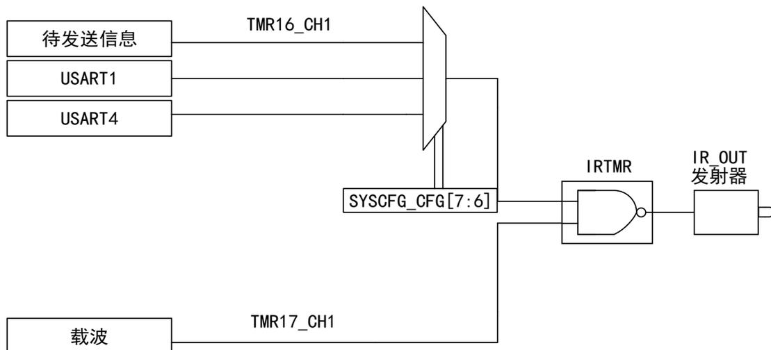
为了产生正确的红外遥控信号，需要正确配置 TMR17\_CH1 提供一个高频载波信号，而 TMR16 提供我们发送的信息即可。
