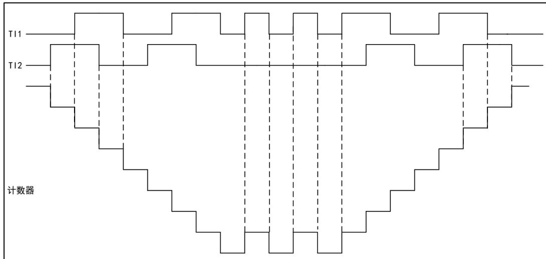
例如：当 TI1 处于低电平时，TI2 发生上升沿跳变，计数器向下计数。
