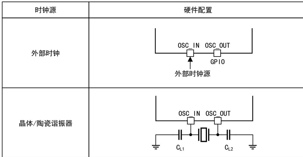
为了减少时钟输出的失真和缩短启动稳定时间，晶体/陶瓷谐振器和负载电容器必须尽可能地靠近振荡器引脚。负载电容（ $C_{L1}$ 、 $C_{L2}$ ）的值必须根据所选择的振荡器来调整。
