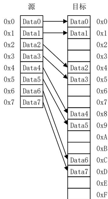
图 15 源为 32bits 目标为 16bits 的传输宽度
