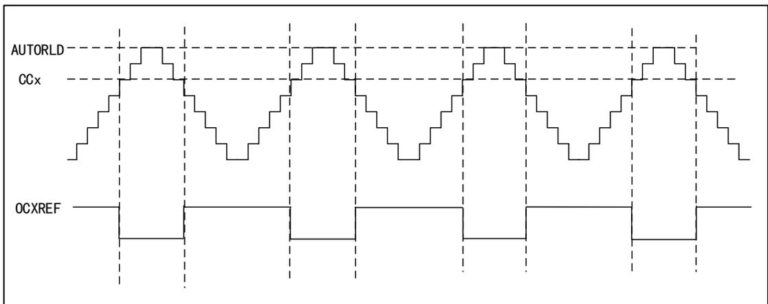
PWM 模式 2 中如果计数器 CNT 的值小于比较寄存器 CCx 的值，输出无效电平，否则反之。
