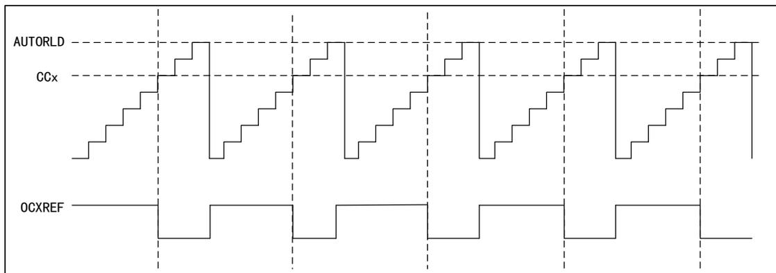
图 56 PWM1 向下计数模式的时序图
