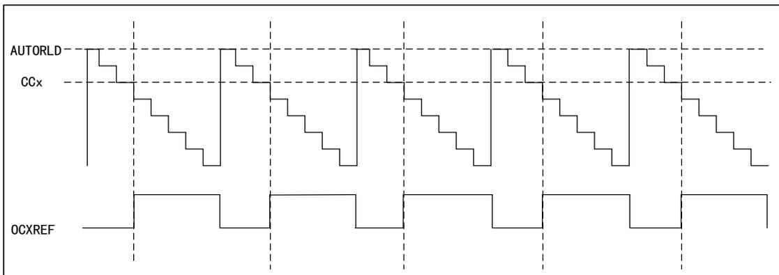
图 47 PWM1 中央对齐模式的时序图
