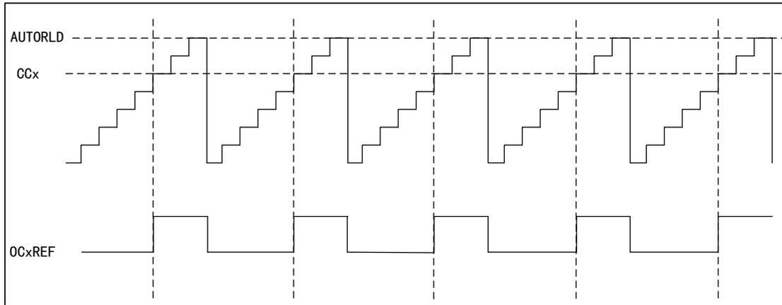
图 49 PWM2 向下计数模式的时序图
