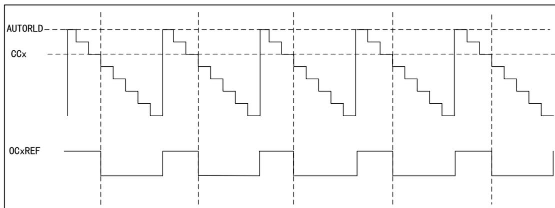
图 77 PWM2 中央对齐模式的时序图
