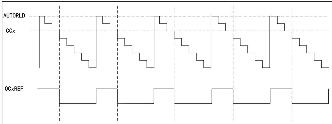
图 60 PWM2 中央对齐模式的时序图
