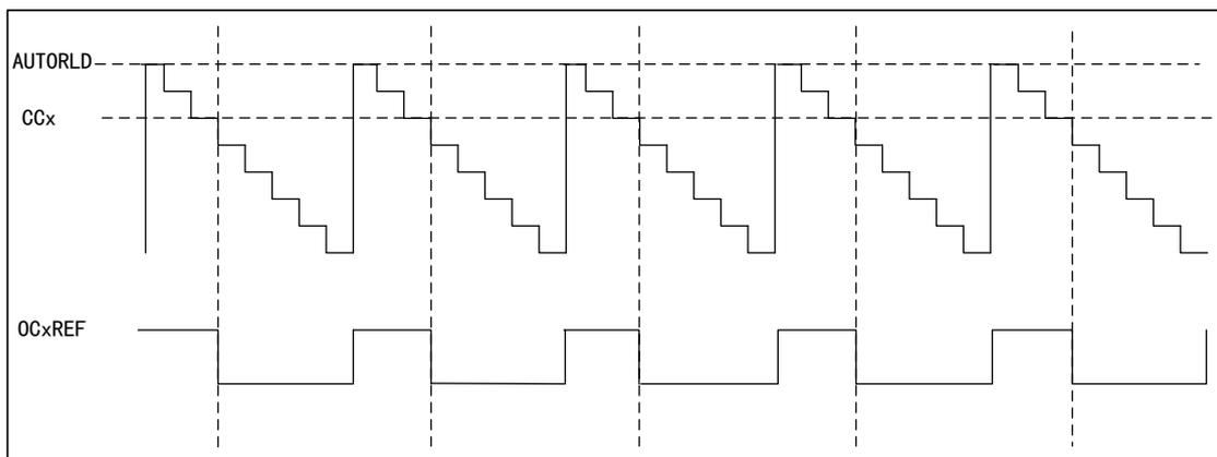
图 34 PWM2 中央对齐模式的时序图
