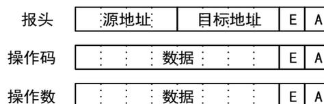
一次完整的通信包含起始位、报头、操作码以及最大长达 15 个消息的操作数。
