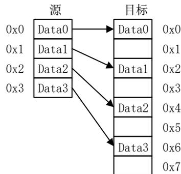
图 11 源为 8bits 目标为 32bits 的传输宽度
