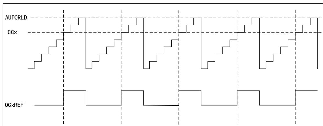
图 59 PWM2 向下计数模式的时序图
