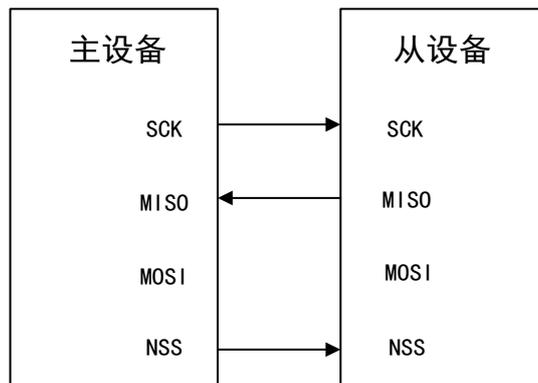
图 114 单工模式连接（主机只发送，从机接收）
