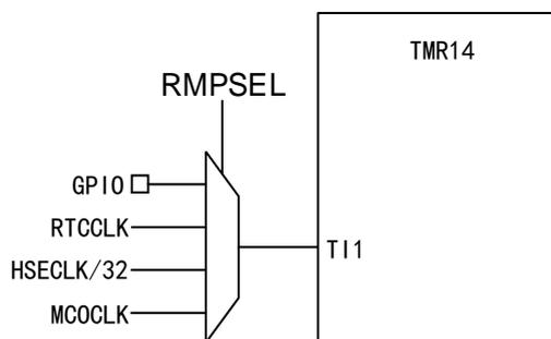
TMR14 的输入捕获可以选择通过配置 TMR14 的 TMRx\_OPT 寄存器的 RMPSEL 位，连接一个 GPIO 端口或一个 MCU 的内部时钟（RTCCLK，HSECLK/32，MCOCLK）。具体配置见该寄存器。
