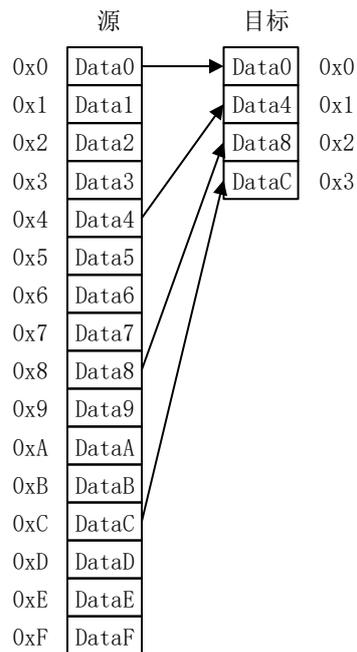
图 13 源为 16bits 目标为 16bits 的传输宽度
