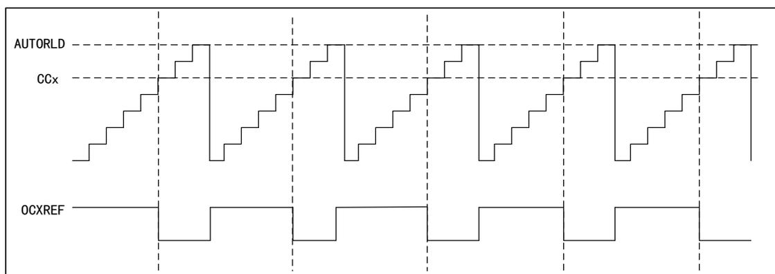
图 73 PWM1 向下计数模式的时序图
