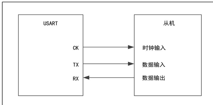
图 96 USART 同步传输时序图 (DBLCFG=10)
