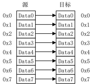
图 14 源为 16bits 目标为 32bits 的传输宽度
