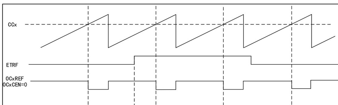
将 TMRx 置于 PWM 模式，关闭外部触发预分频器，禁止外部触发模式 2，当 ETRF 输入为高时，通过设置 OCxCEN=1，输出的 OCxREF 信号如下图。
