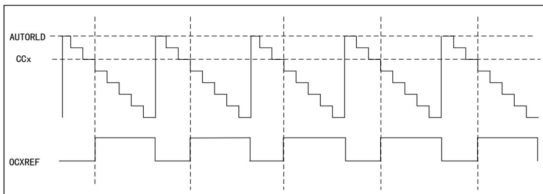
图 57 PWM1 中央对齐模式的时序图
