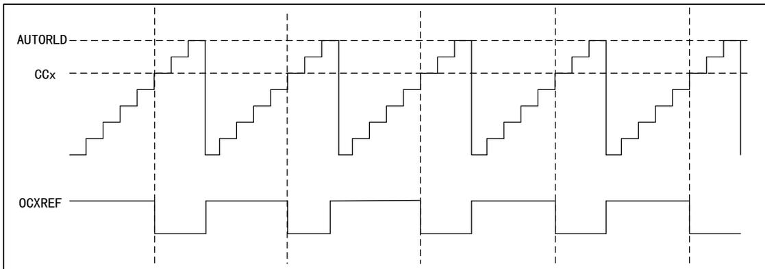
图 30 PWM1 向下计数模式的时序图
