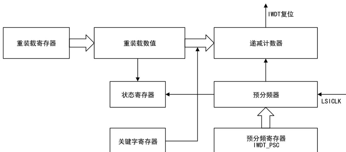
注：预分频器、重载数值和递减计数器在 V<sub>DD</sub> 供电区内；预分频寄存器、状态寄存器、重载寄存器和关键字寄存器在 1.5V 供电区。看门狗功能处于 V<sub>DD</sub> 供电区，可以在停机或者待机模式下正常工作。
