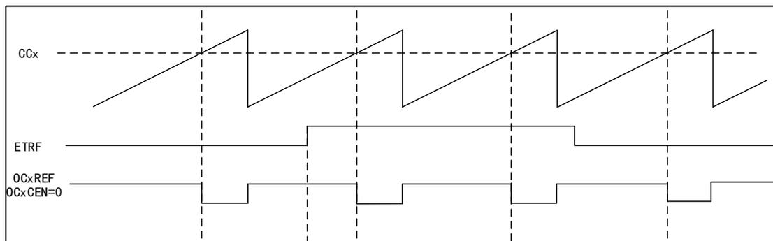
将 TMR1 置于 PWM 模式，关闭外部触发预分频器，禁止外部触发模式 2，当 ETRF 输入为高时，通过设置 OCxREN=1，输出的 OCxREF 信号如下图。
