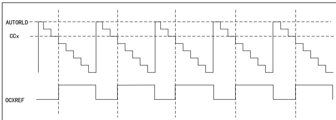
图 74 PWM1 中央对齐模式的时序图
