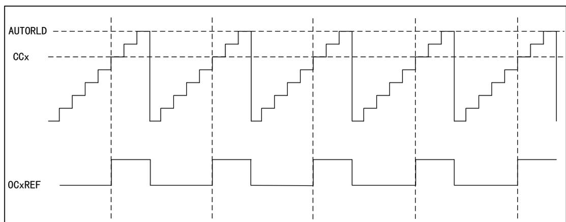
图 76 PWM2 向下计数模式的时序图
